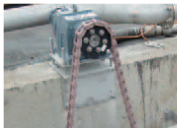
Azionamento sul bilico del motore Protezione dai sovraccarichi mediante potenza attiva
