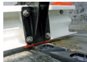
Corsa a pavimento con rotaie in PE e pattini in PU
